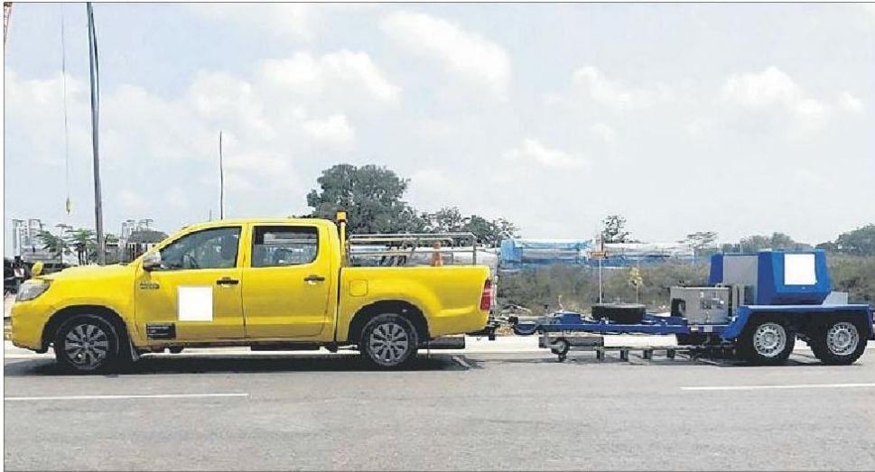
除了使用视频分析技术和人工智能检测道路状况，陆路交通管理局目前也使用专用设备评估路面性能，包括使用图中的落锤式弯沉仪（Falling Weight Deflectometer）评估道路的结构完整。（陆交局提供）
