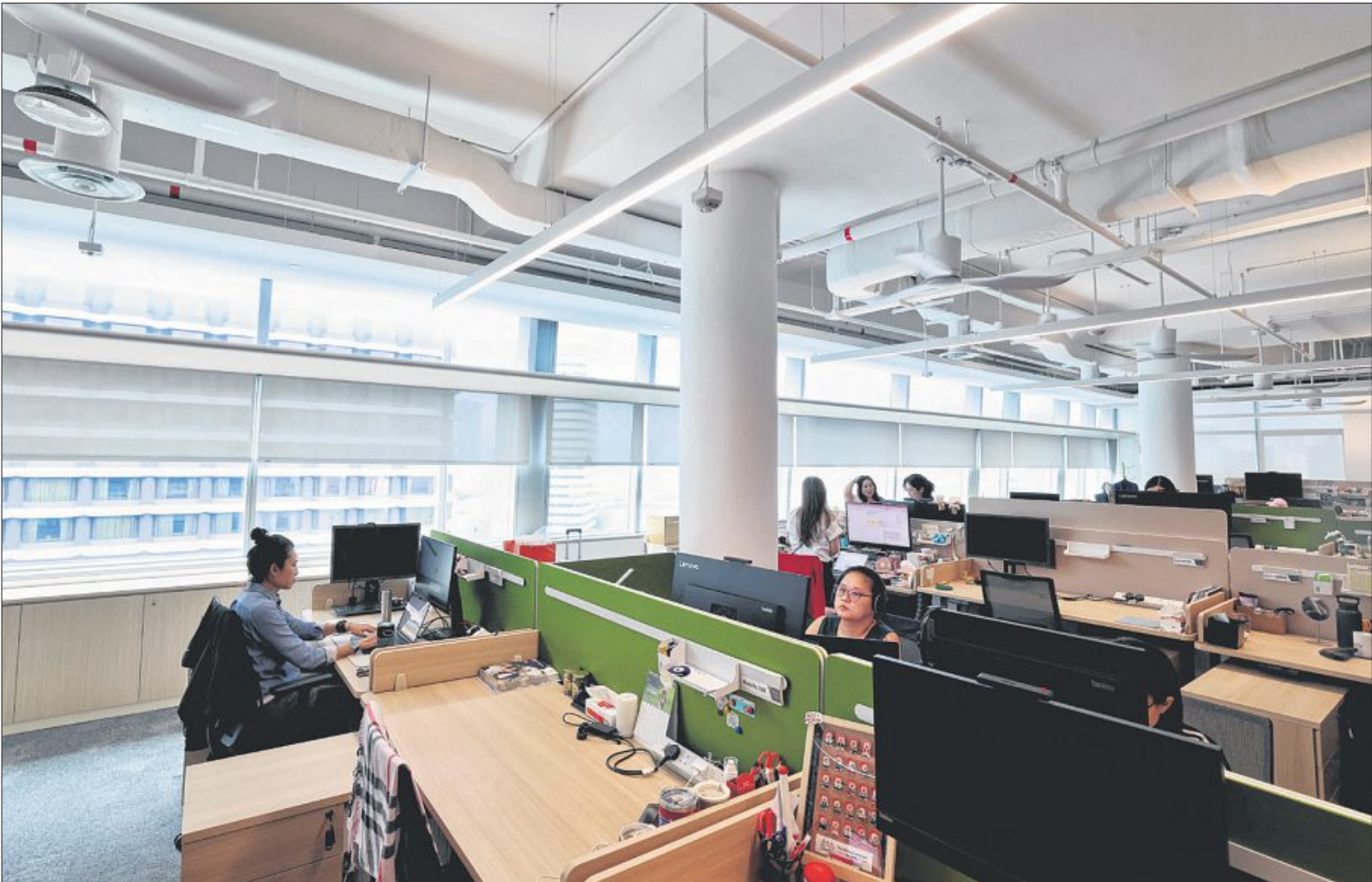
新加坡管理大学的行政大楼结合传感器、采光架、自动百叶窗、混合冷却技术等的使用，在为办公室引进自然光的同时，保持舒适怡人的室内温度，并大幅度节省用电。（唐家鸿摄）
