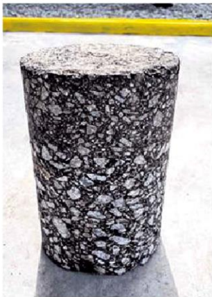
Magorium通过创新技术将废弃塑料加工后，取代铺路材料中的部分沥青，使回收的塑料获得新生。
