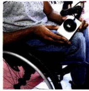
安装在轮椅上的感应器，可用来记录出行的路线和遇到的道路障碍等。（陈未福摄）
